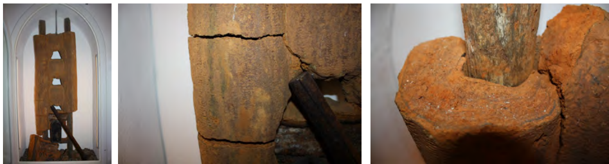
Abbildung 1: Die versinterte Fahrt (ca. 1,5x0,5 m) aus der Roten Grube, Stadt- und Bergbaumuseum Freiberg, 2021, mit Details von Schadensbildern (Risse und geschrumpfter Holzkern) sowie der Zonierung des Überzugs. ©SBM/photographisches.com/Thomas Kruse.
