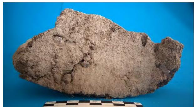
Abb. 2 Kalkmörteloberfläche mit Kalksinterschicht
